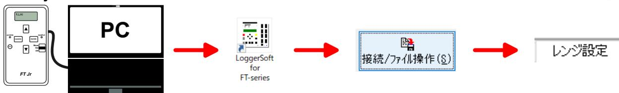
レンジ設定を選択後に演算式の値とセンサー本体ラベルに記載してあるCoefficientが一致しているかを確認して下さい。一致していない場合は必ず正しい値を入力して保存して下さい。
