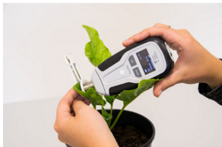
E-FP110/D (PAR-E-FP110/D) 脱着式クリップで簡単に暗処理が可能。
