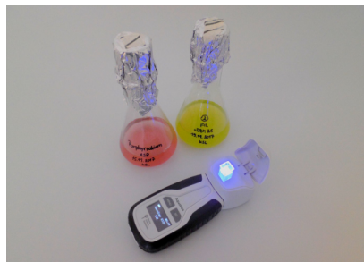
E-AP110 / C サンプルをキュベットに入れて計測。 高感度0.5µg Chl / L。植物プランクトン、シアノバクテリア。 光学密度の測定が可能。
