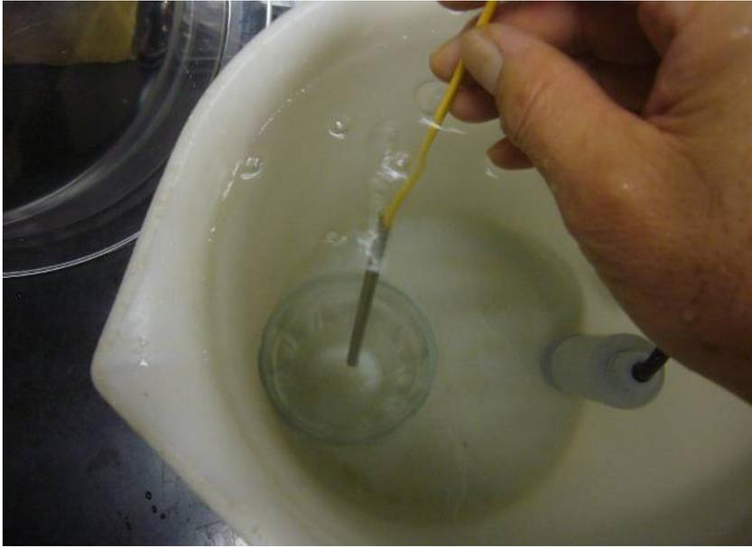
受感部(ステンレスパイプ)内の気泡が抜けにくい場合は竹串等を挿入すると気泡が抜けます。しばらく浸漬し、先端部のポーラスストーンを脱気します。
