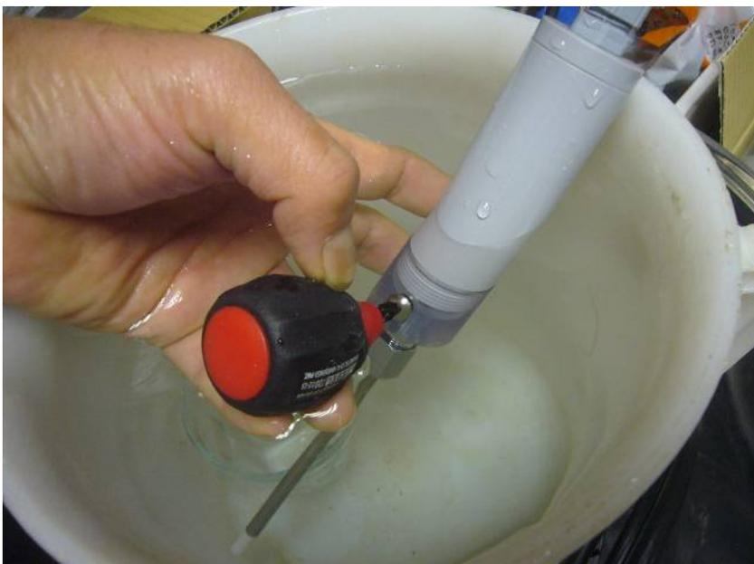
最後に側面のネジをドライバーで締めます。Oリングを忘れずに付けて下さい。
