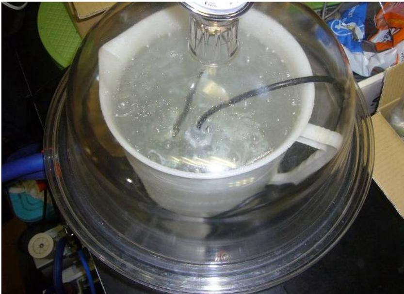
真空ポンプで気泡が抜けるまで脱気します。(数時間ほど)
