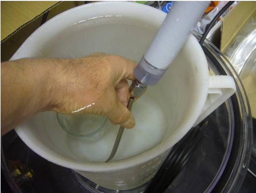
気泡が抜けたのを確認したら水中で組み立てます。
