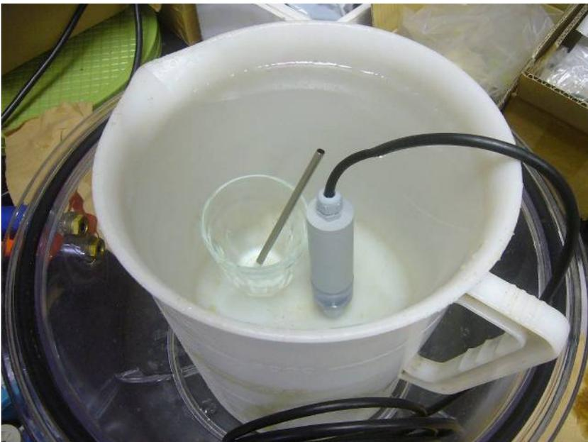
本体と受感部(ステンレスパイプ)を水没させます。このとき、センサーケーブルの末端が水に濡れない様に注意してください。
