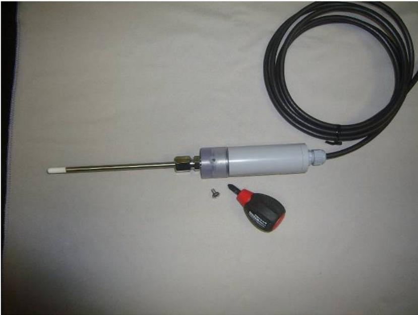
側面のネジを+ドライバーで外します。
