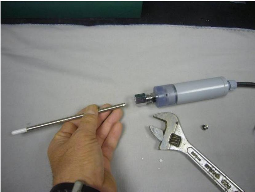
スパナでナットを緩め、受感部(ステンレスパイプ)を引き抜きます。
