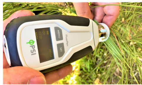
4. SETボタンを押すだけで簡単に計測可能。 左のE-FP110/S同様に松の葉1本だけでも計測は可能です。
