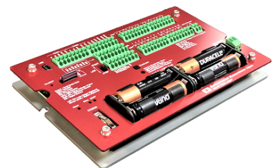
MIJ-01 マルチチャンネルロガー (DIFF 8ch SE 16ch)
