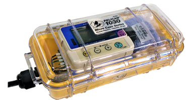
MIJ-12防水ロガー (1ch) LM1本のみ使用する場合
