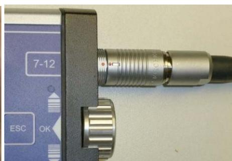
正しくソケット(B)に7~12のセンサーを取り付けた状態
