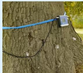
2. ストラップにモジュールを装着して釘にセンサーを取付けます。
