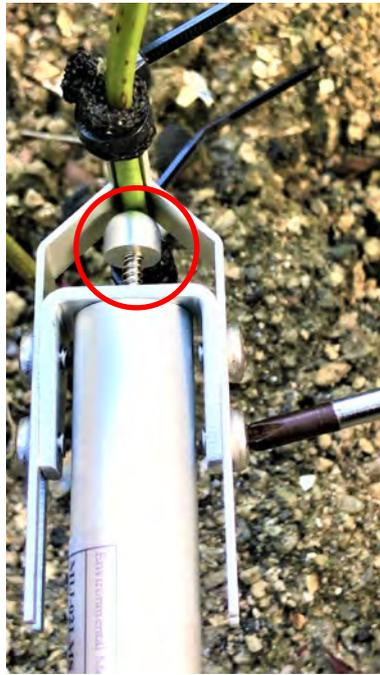
この写真は説明の為、極端に縮めております。本来は1~2mm程度縮めてください。スプリングが縮んだ状態でハンマーヘッド固定ネジを締めて下さい。
