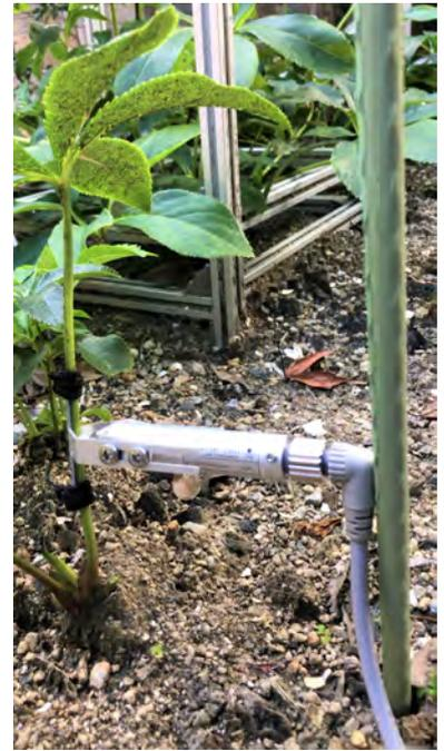
センサーの設置が終わったら添え木を地面に差し込みケーブルを添え木に固定します。
