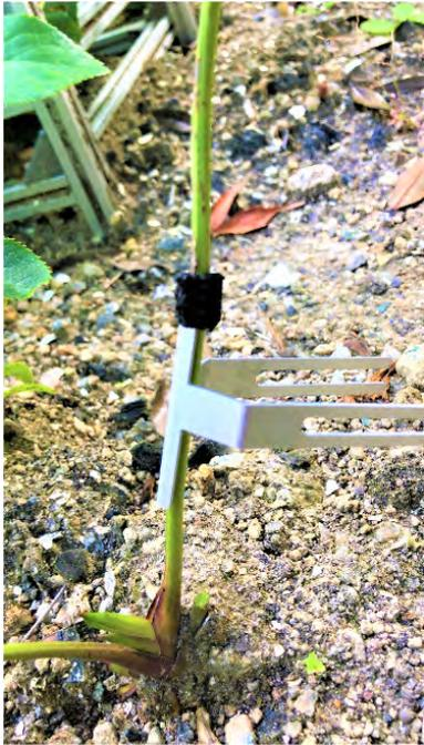
ハンマーヘッドをサンプルに装着します。付属のエプトシーラを適切(1.5巻)な長さにカットし、ハンマーヘッドと茎を固定します。
