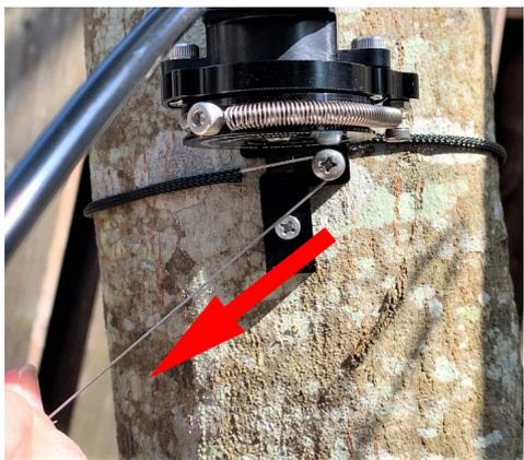
**10.** ワイヤーロックにワイヤーを引っ掛けます。この時、Step9で1~2mmワイヤーを動かした動作と連動してやることを忘れて下さい。Step4の繰り返しになりますがワイヤーがアーム切込み部に沿うようにして下さい。
