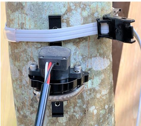
2. 先に本体アーム上部を非破壊キットで軽く固定します。まだバンドのロックはしないようにして下さい。バックルがデンドロ本体に近過ぎないようにして下さい。
