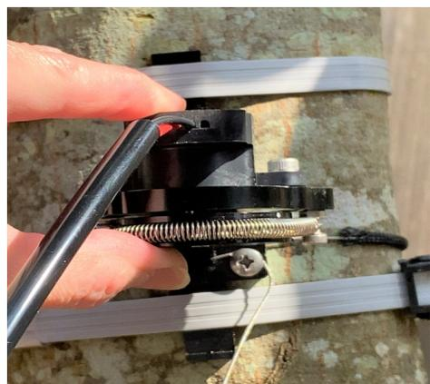
5. ぐらつきが無く、固定できたか確認します。非破壊での固定は、タッピングネジでの固定よりはぐらつきは生じます。ベルトが長すぎる場合は任意で切っていただいても構いません。
