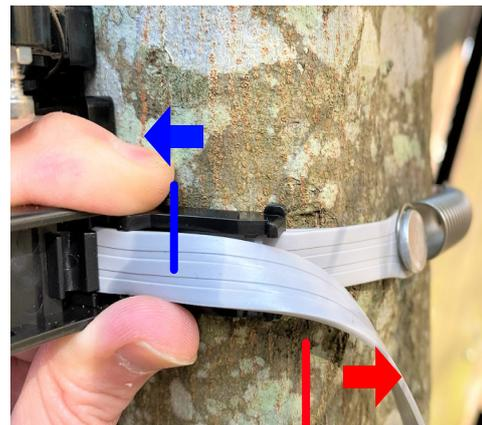
3. 非破壊キットのバックルを矢印青方向に引っ張りベルトを矢印赤方向に引っ張り十分な固定ができるところでロックして下さい。アーム下部も同じく固定して下さい。
