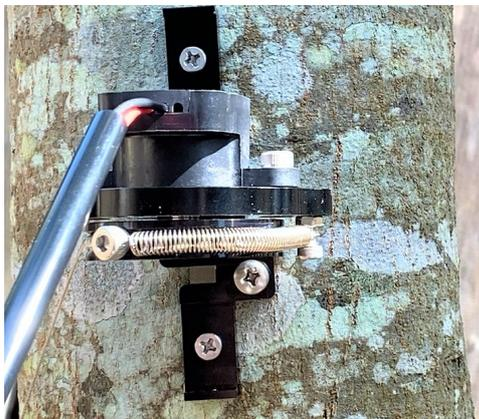
1. なるべく凹凸のない場所を選び設置してください。ワイヤーも可能な限り凹凸のない場所に巻き付けて下さい。プラスドライバサイズNo2を使用しタッピングスクリーをアームの穴2箇所からねじ込み、樹幹に固定します。
