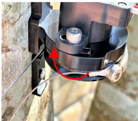
4. ワイヤーを矢印の方向に入れ込みます。プーリーの溝にワイヤーが沿う様にして下さい。右写真のようにデンドロの右側からワイヤーが出てきます。ワイヤーは必ずアームの斜め切込み部に沿うようにして下さい。
