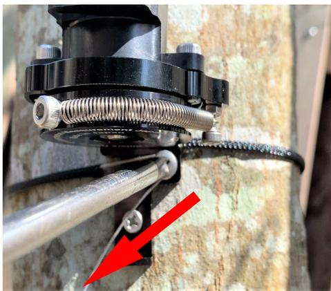
**11.** ワイヤーを引っ張った状態でワイヤーロックを締めます。締めこむときはワイヤーを写真の方向に引きつつ締めこみます。
