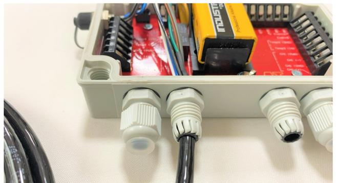
6. パッキンがケーブルグラントに確実に入っているか確認して下さい。ケーブルグラントのキャップを閉めワイヤーを指定のポートに接続して下さい。
