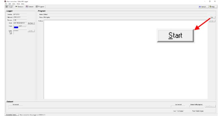
1. GP1本体に計測開始ボタンはありません。PCに繋いだ状態でStartをクリックし計測開始になります。計測開始になるとStartがStopボタンに変わります。計測終了する際は、Stopボタンをクリックするだけです。
