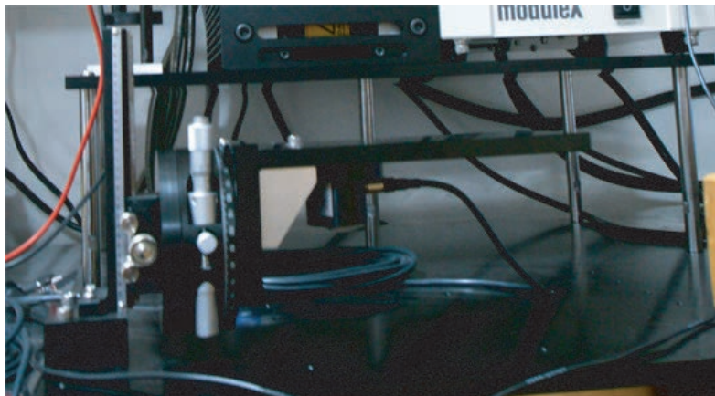
入射角特性テスト用実験装置
