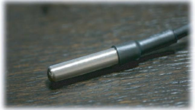
高精度で直線性が高い温度センサーをIC温度センサーをベースに開発しました。土壌、水中、大気など各種温度の計測に利用できます。サーミスタだとB常数設定の理由でロガーとのバック品でないといけない、熱電対だと直線性が高く使いやすい一方で精度が望めない、RTD（白金）だとシャント抵抗その他の周辺機材が必要となり、配線がめんどくさく、価格も可愛くない、と言った一長一短があります。LTPは精度、使いやすさ、堅牢性、価格を優先していますので、お手軽に高精度、高分解能での計測が可能になり、かつ直線性が高いため、温度への換算も容易に行えます。
