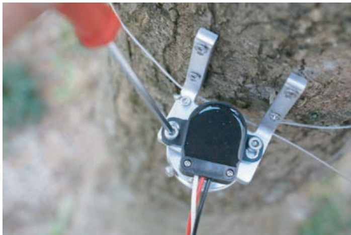
7. ポテンショ固定ネジ2本をゆるめます。 六角穴対辺3.0mm
