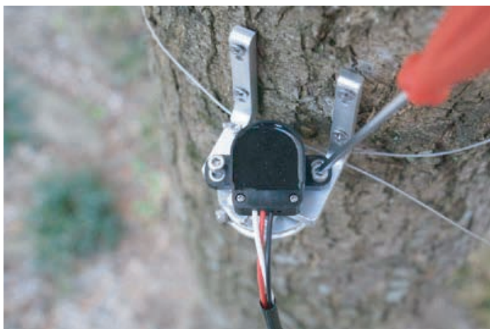
8. ポテンショを10度回転させ、固定ネジ2箇所を締め込みます。 この操作でワイヤーに初期テンションを与えることができます。 ワイヤーのテンションの加減は4の操作と8の操作で決定されま すので7と8の操作を行うか否かは任意に判断してください。
