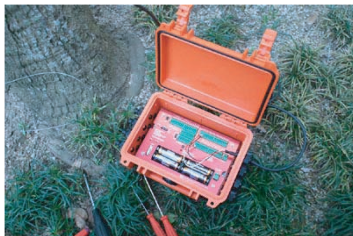
12. 延長ケーブルをデータロガーに接続します。配線方法は次項 を確認してください。
