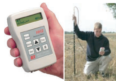
ハンディロガーHH2と直接接続できます。
